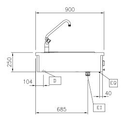
Electrical inlet (power) ΕI EQ Equipotential screw
